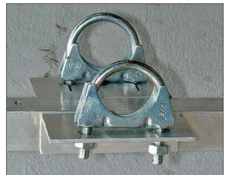
Bild 9: Kreuzhalterung zur Befestigung des Booms am Mast
