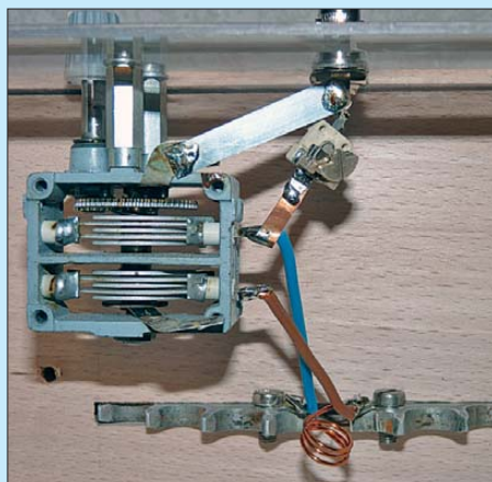
Bild 2: Blick auf das Anpassnetzwerk; Zahnkranz, Anpassspule und Doppeldrehkondensator liegen alle parallel und bilden einen Schwingkreis. Die Auskopplung zum Transceiver erfolgt über den Lufttrimmer.
