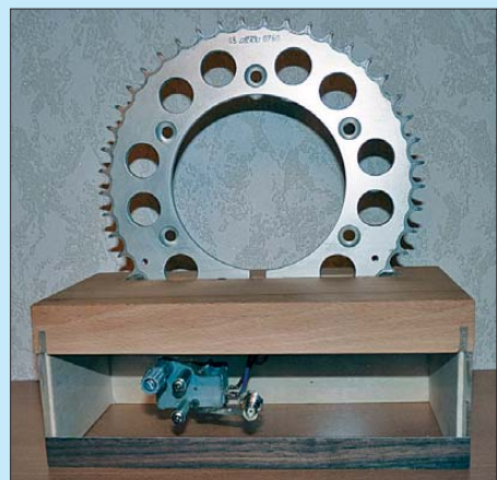
Bild 1: Gesamtansicht der Zahnkranz-Antenne; der gezackte Außenrand der Schleife macht sich übrigens weder in Form von erhöhter Oberwellenabstrahlung noch als raue Modulation bemerkbar. Fotos: DB1NV
