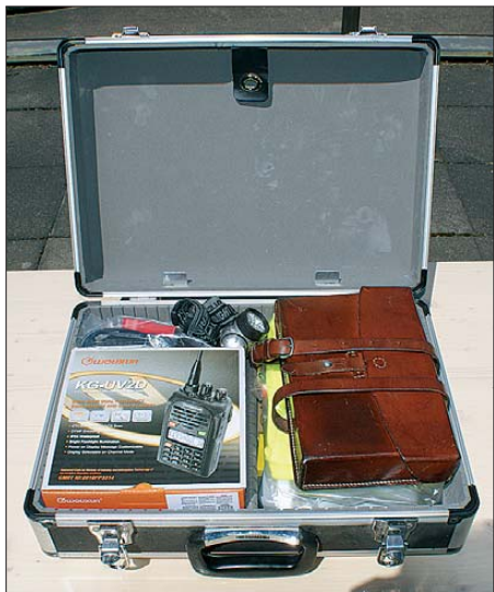
Bild 1: Der in diesem Beitrag vorgestellte Notfunkkoffer enthält die komplette Ausrüstung für den effizienten Funkbetrieb auf 2 m und 70 cm.
