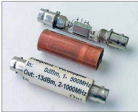
Bild 12: Eigenbau eines Verdopplers mit dem Mischer TUF-1 im Kupferrohrgehäuse
