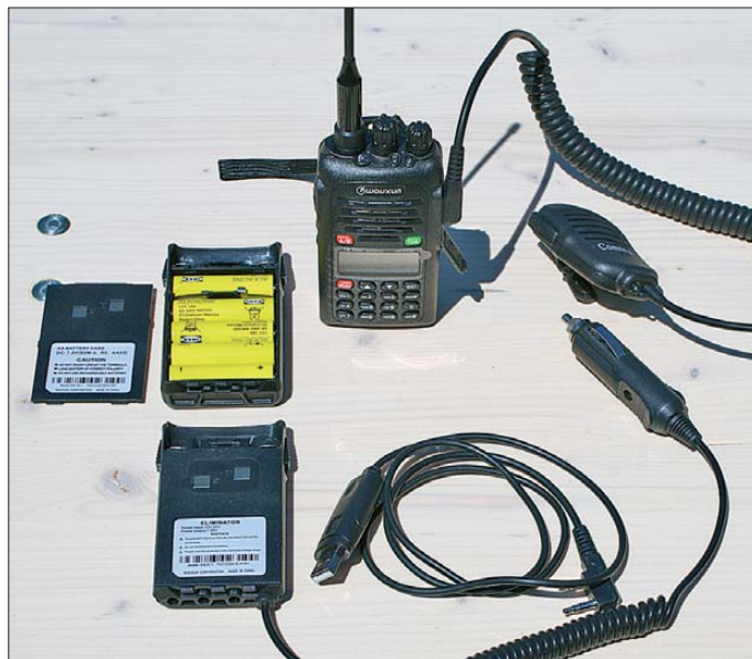
Bild 2: Neben dem Funkgerät gehören diverse Möglichkeiten für die Stromversorgung zur Grundausstattung des Notfunkers.
