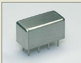
Tiefpass- und Hochpassfilter sind in hermetisch geschlossenen Metallgehäusen untergebracht.
