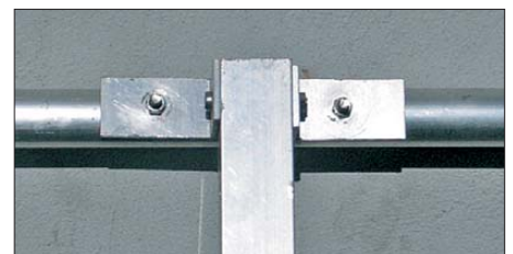
Bild 8: Die Halterung der aus Aluminiumrohren bestehenden Parastärelemente auf dem eckigen Boom erfolgt mit kleinen Winkeln.
