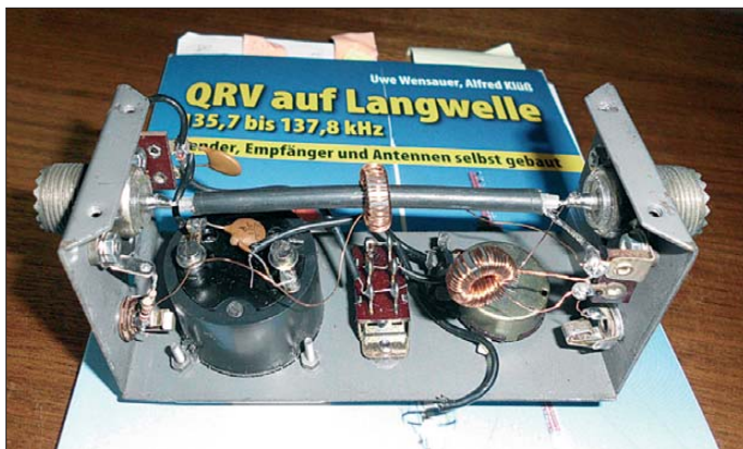
Bild 14: Umgebautes KW-Stehwellenmessgerät – es dient jetzt für Messungen im Mittelwellenbereich.
