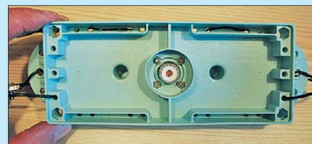
Bild 4: Die untere Gehäuseschale mit der hochgelegten SO239-Buchse im Tropfrand
