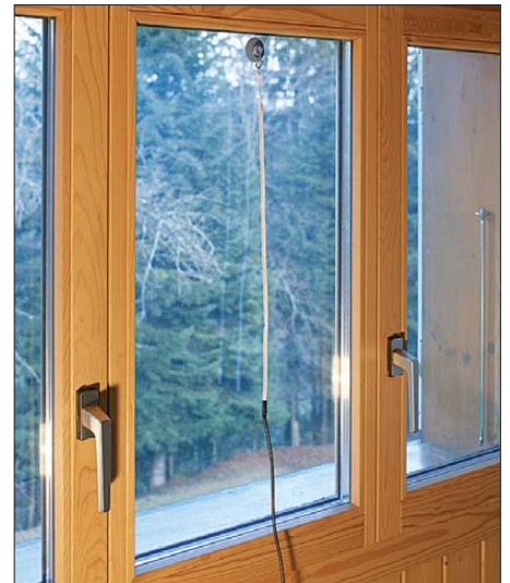
Bild 7: Ein Saugnapf hält die Notfunkantenne an ihrem Platz.
