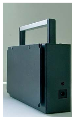
Bild 2: Bei heruntergeklappter Platte ist das Display geschützt und der Einschalttaster kann nicht betätigt werden.
